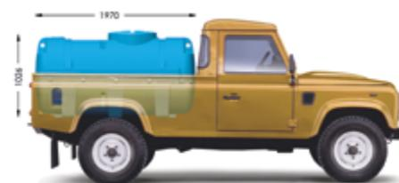
Illustration à l'échelle d'une cuve CA1250 embarquée sur un pick-up
